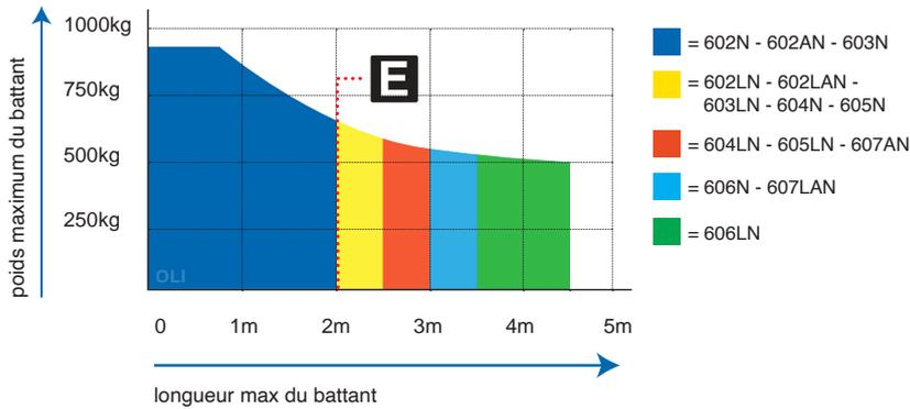
Si la longueur du vantail est supérieure à 2m ou si vous utilisez des modèles réversibles il faut installer l'électro-serrure pour verrouiller la porte en position de fermeture. La hauteur et la structure du vantail, ainsi que la présence de vent fort, peuvent provoquer la réduction des valeurs contenues dans cette table ou obliger à utiliser une serrure électrique aussi pour les vantaux de moins de 2m.
