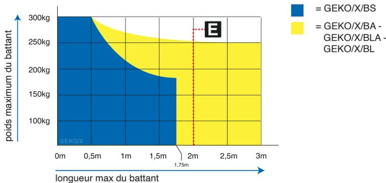
Si la longueur du vantail est supérieure à 2m ou si vous utilisez des modèles réversibles il faut installer l'électro-serrure pour verrouiller la porte en position de fermeture. La hauteur et la structure du vantail, ainsi que la présence de vent fort, peuvent provoquer la réduction des valeurs contenues dans cette table ou obliger à utiliser une serrure électrique aussi pour les vantaux de moins de 2m.
