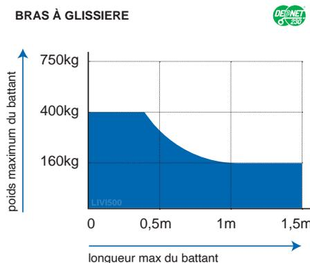
Important: installez l'électro-serrure pour verrouiller la porte en position de fermeture. La hauteur et la structure du vantail, ainsi que la présence de vent fort, peuvent provoquer la réduction des valeurs contenues dans cette table.
