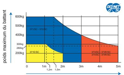
Si la longueur du vantail est supérieure à 2m ou si vous utilisez des modèles réversibles il faut installer l'électro-serrure pour verrouiller la porte en position de fermeture. La hauteur et la structure du vantail, ainsi que la présence de vent fort, peuvent provoquer la réduction des valeurs contenues dans cette table ou obliger à utiliser une serrure électrique aussi pour les vantaux de moins de 2m.
