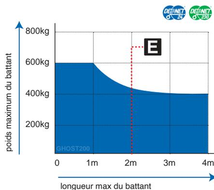
Si la longueur du vantail est supérieure à 2m ou si vous utilisez des modèles réversibles il faut installer l'électro-serrure pour verrouiller la porte en position de fermeture. La hauteur et la structure du vantail, ainsi que la présence de vent fort, peuvent provoquer la réduction des valeurs contenues dans cette table ou obliger à utiliser une serrure électrique aussi pour les vantaux de moins de 2m.
