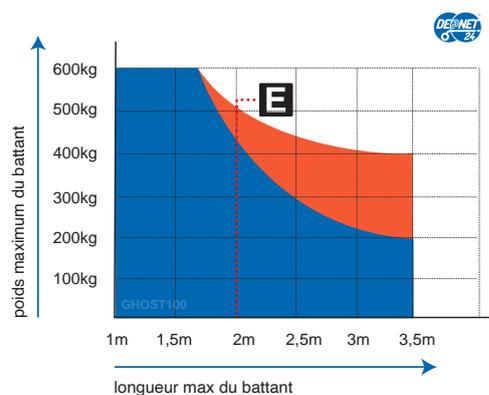
Si la longueur du vantail est supérieure à 2m ou si vous utilisez des modèles réversibles il faut installer l'électro-serrure pour verrouiller la porte en position de fermeture. La hauteur et la structure du vantail, ainsi que la présence de vent fort, peuvent provoquer la réduction des valeurs contenues dans cette table ou obliger à utiliser une serrure électrique aussi pour les vantaux de moins de 2m.
