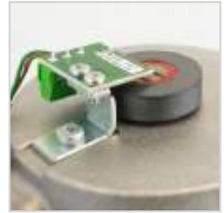
Contrôle du mouvement du moteur par encodeur magnétique qui garantit une précision et une sécurité maximales
