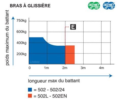
Si la longueur du vantail est supérieure à 2m ou si vous utilisez des modèles réversibles il faut installer l'électro-serrure pour verrouiller la porte en position de fermeture. La hauteur et la structure du vantail, ainsi que la présence de vent fort, peuvent provoquer la réduction des valeurs contenues dans cette table ou obliger à utiliser une serrure électrique aussi pour les vantaux de moins de 2m.
